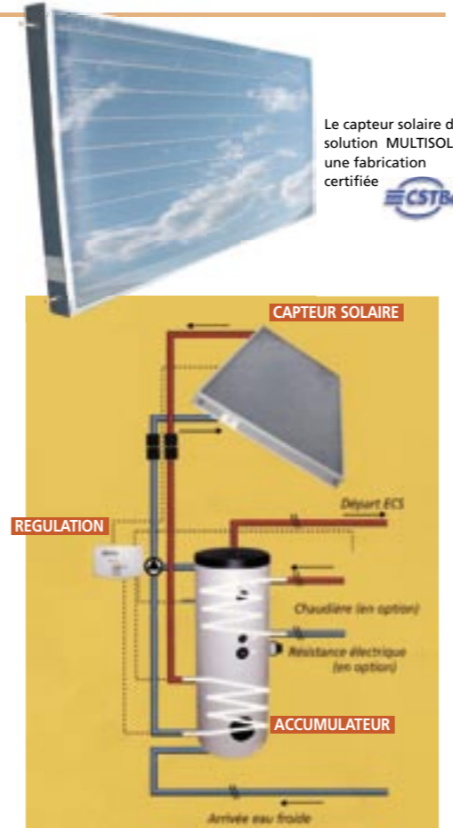
Principe de fonctionnement d'une installation MULTISOLAR SOLO (eau chaude sanitaire).
